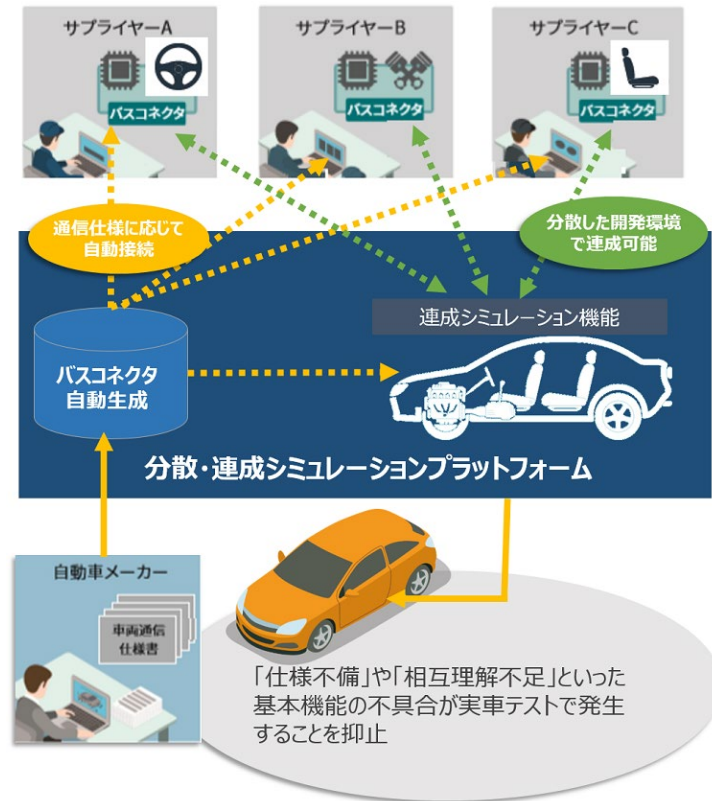
図 1 分散・連成シミュレーションプラットフォームの概要図
